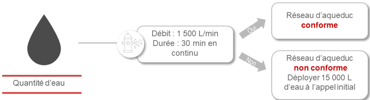
Figure 5 : Quantité d'eau déployée à l'appel initial, selon la conformité du réseau d'aqueduc
